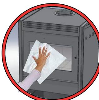
Pravidelne čistite sklo dvierok a kontrolujte dvierka aj tesnenie. Poškodené tesnenie dvierok môže skrátiť dobu horenia a môže poškodiť spaľovaciu komoru. Počas prikladania dreva dbajte na to, aby poleňa nevyčnievali z ohniska. Mohlo by dôjsť k ich kontaktu so sklom na dvierkach. Dvierka kachlí zatvárajte opatrne a vyhnite sa akýmkoľvek nárazom do skla.
