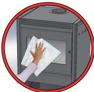
Pravidelne čistite sklo dvierok a kontrolujte dvierka aj tesnenie. Poškodené tesnenie dvierok môže skrátiť dobu horenia a môže poškodiť spaľovaciu komoru. Počas prikladania dreva dbajte na to, aby polená nevyčnievali z ohniska. Mohlo by dôjsť k ich kontaktu so sklom na dvierkach. Dvierka kachlí zatvárajte opatrne a vyhnite sa akýmkoľvek nárazom do skla.
